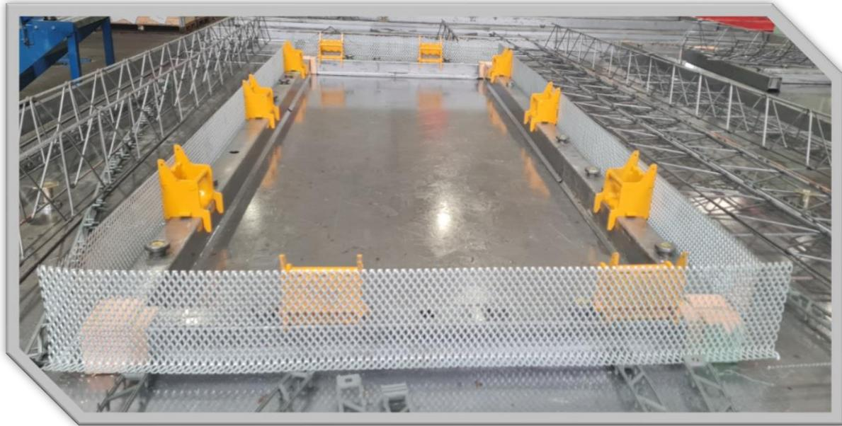
Les coffrages métalliques permettent une mise en place facile en usine.
