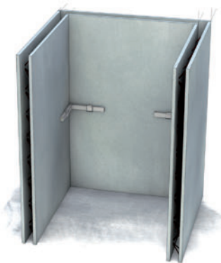
Figure 23. Exemple de gaine d'ascenseur
