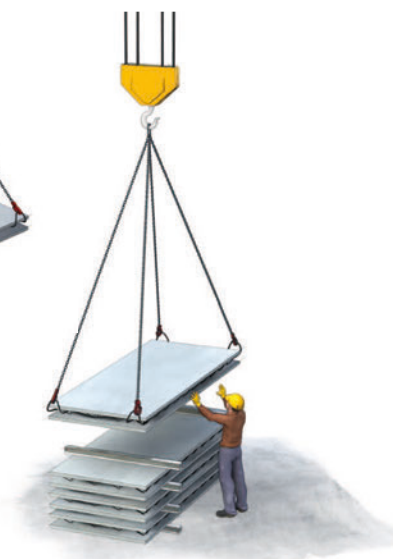
Figure 15. Utilisation de quatre crochets de levage
