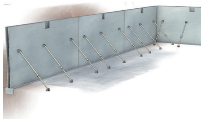
Figure 26. Stabilisation par étais tirants-poussants
