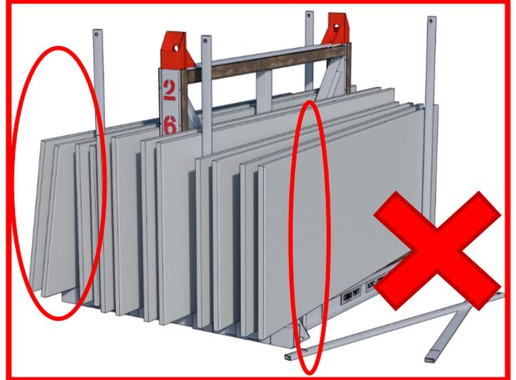
Interdiction de retirer un poteau avant de retirer un prémur.
